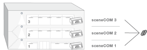
Bild 40: Konfiguration der Vernetzung in einem Treppenhaus
