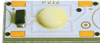
powerLED P211, Beschädigung durch Lösungsmitteldämpfe
