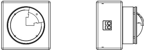
Befestigen Sie die Abdeckung für den Erkennungsbereich am Sensor, indem Sie sie in die entsprechende Nut an der Vorderseite des Sensors einführen. Shutter sind für den einmaligen Gebrauch bestimmt, ein Ausbau nach der Installation kann den Shutter und die Sensorlinse beschädigen! Wenn Sie einen beschädigte Shutter an den Sensor montieren, ist die Gefahr groß, dass der Shutter abfällt!
