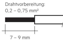
Den Drücker der Klemme betätigen um flexible Leiter einzuführen oder die Klemme zu lösen.
