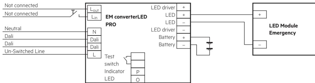
**EM converterLED PRO mit einem Standard LED-Treiber und einem LED-Modul für Netz- und Bereitschafts-Notbetrieb**
