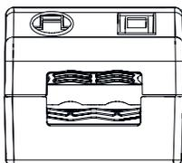
Sekundäre Zugentlastung für Kabel mit kleinerem Kabelmantel
