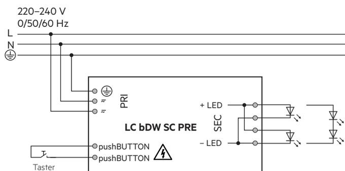
**!** Empfehlung zur Überprüfung des Glühens im Standby in Kombination mit Leuchten der Schutzklasse I.
