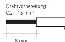
Sekundäre Zugentlastung für Kabel mit größerem Kabelmantel
