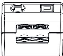
Sekundäre Zugentlastung für Kabel mit kleinerem Kabelmantel
