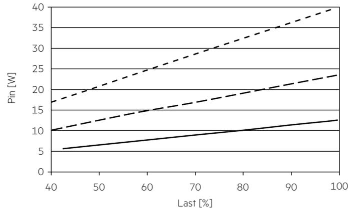
4.5.1 Eingangsleistung in Abhängigkeit zur Last 120 V, 60 Hz
