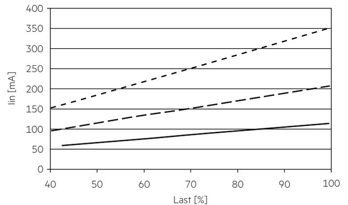
4.4.2 Eingangsstrom in Abhängigkeit zur Last 230 V, 50 Hz
