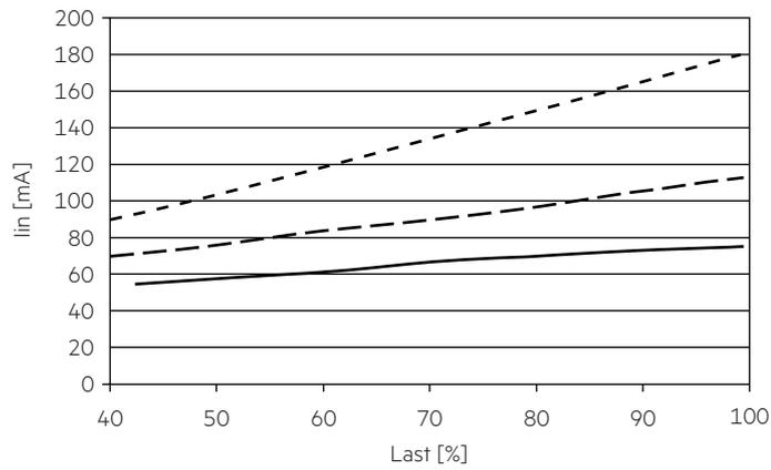
4.5.2 Eingangsleistung in Abhängigkeit zur Last 230 V, 50 Hz
