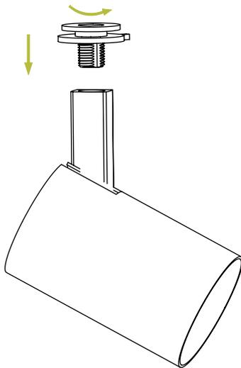
2. Der Nippel wird im Treiber eingesetzt.
