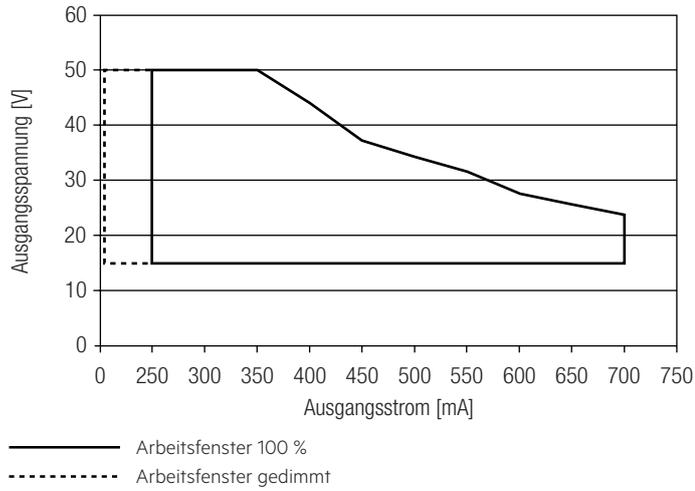
Es ist sicherzustellen, dass der LED-Treiber ausschließlich innerhalb des gezeigten Arbeitsfensters betrieben wird. Besondere Aufmerksamkeit ist dem gedimmten Betrieb sowie dem DC- und Notlichtbetrieb zu widmen, da aufgrund der verwendeten Amplituden-Dimming die Modulspannung mit dem Dimm-Level variiert. Eine Unterschreitung der spezifizierten minimalen Ausgangsspannung des LED-Treibers kann zur Abschaltung führen. Siehe Abschnitt „6.11 Lichtlevel im DC-Betrieb“ für mehr Informationen.
