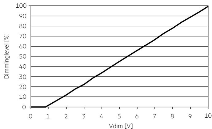
BRIDGE sendet den Bereitschaftsbefehl an die LMI-LED-Treiber vom Betrieb bis zum Bereitschaftszustand für eine Spannung von <0,8 V und von dem Bereitschaftsmodus für eine Spannung von > 1 V.
