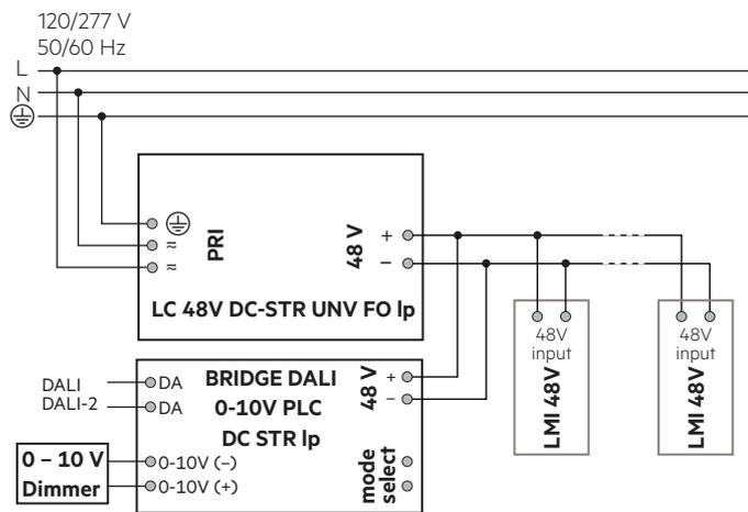
Bei Verwendung der Dimmfunktion dimmbare LMI LED-Treiber mit „DIM“ im Produktnamen.
